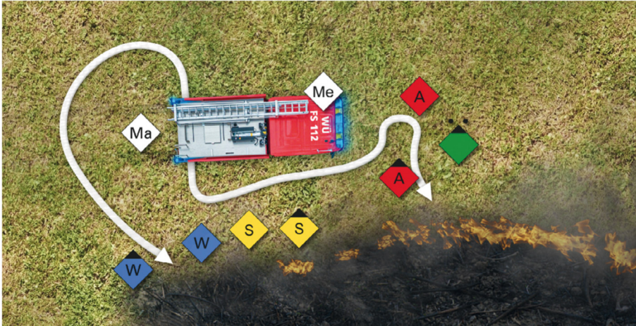
Abb. 6.20: Raupenbetrieb beim Einsatz einer Löschgruppe [2]
