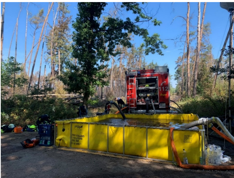
Abb. 6.8: Wasserübergabepunkt mit mobilem Wasserbehälter [HMdIS]
